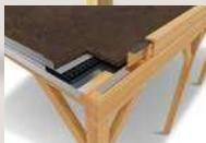
Unterkonstruktion für Dachbegrünung
